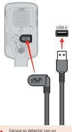
Cargue su detector con un cargador USB de buena calidad que tenga una capacidad de carga mínima de 2 A @ 5 V.
